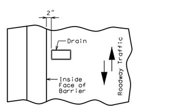
PART PLAN OF SLAB AT DRAIN
