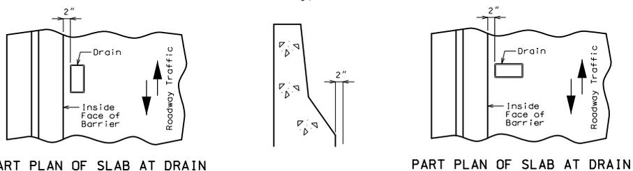
PART PLAN OF SLAB AT DRAIN
