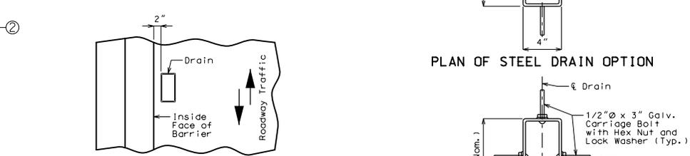
PART PLAN OF SLAB AT DRAIN
