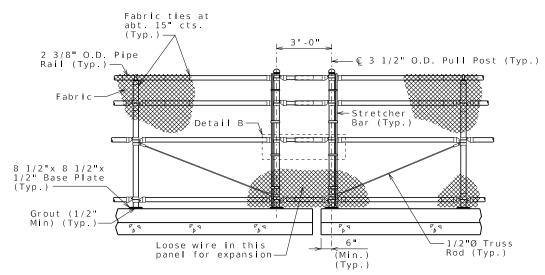
ELEVATION AT EXPANSION GAP
