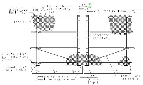
ELEVATION AT EXPANSION GAP
