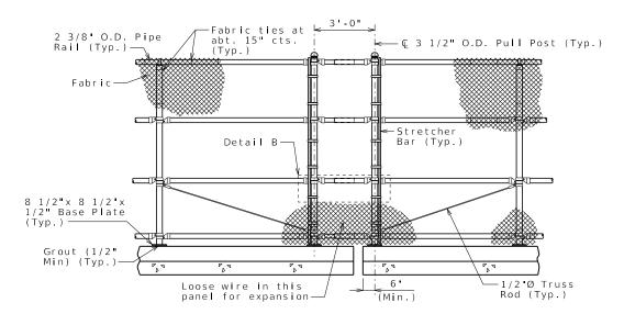
ELEVATION AT EXPANSION GAP
